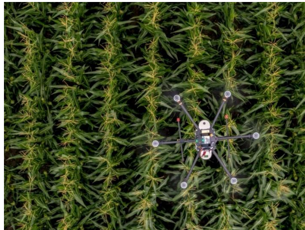
Rysunek 47. Przykład pracy drona aplikującego Kruszyńka – biologicznego antagonistę Omacnicy prosowianki w uprawie kukurydzy. Dron sześciowirnikowy z aplikatorem. Lipiec 2022.
