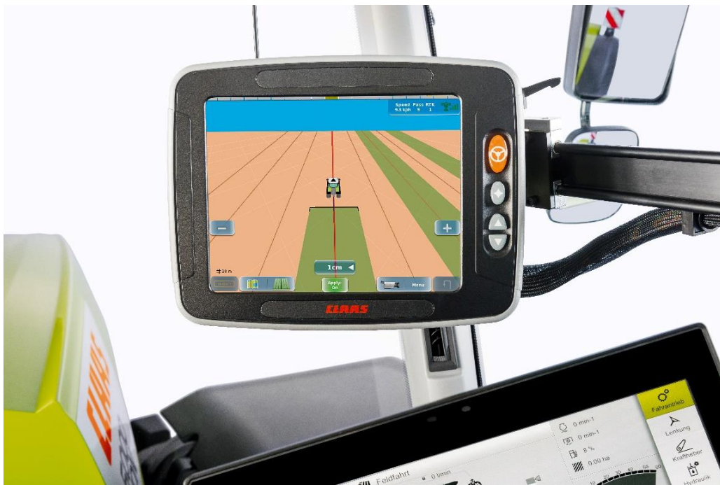
Rysunek 2. Terminal S10, rozwiązanie Claas, dokładność zależy od anteny i sygnału
