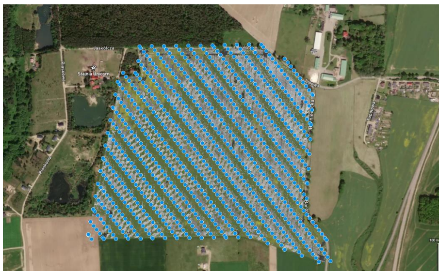
Rysunek 40. Przykład realizacji planu lotu i miejsca wykonania poszczególnych fotografii. Wzajemne pokrycie fotografii wynosi 75% w osi wzdłużnej do linii lotu oraz 80% do osi prostopadłej do lotu. Uprawa ziemniaków Rodzinnego Gospodarstwa Haase Farm w Barniewicach. Loty pomiarowe wykonano w dniu 21.07.2022r.
