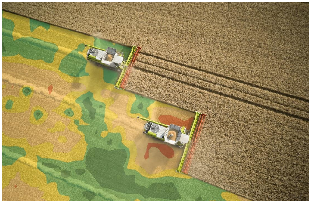
Rysunek 1. Nowoczesny sprzęt do zbioru wyposażony w system mapowania plonów.
