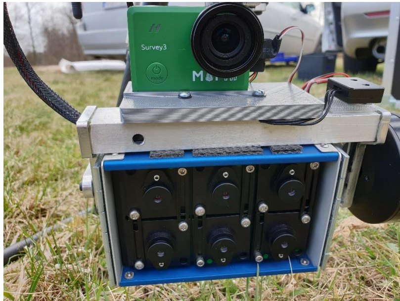
Rysunek 36. Przykład kamery multispektralnej TETRACAM microMCA6 (dolna część konstrukcji) oraz kamery światła widzialnego MAPIR Survey 3 (górna część konstrukcji).
