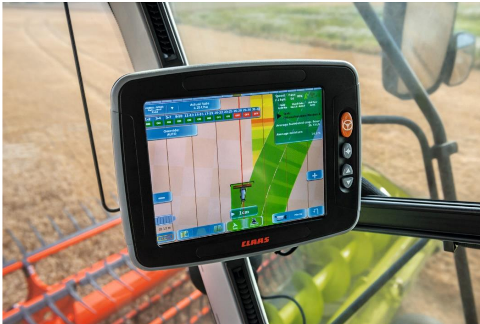
Rysunek 11. Prowadzenie równoległe i mapowanie plonu podczas pracy kombajnu
