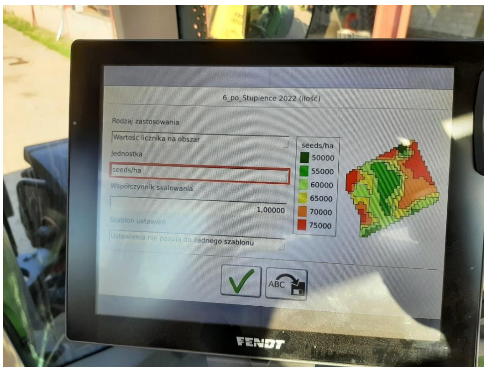
Rysunek 24. Mapa aplikacyjna zmiennej ilości wysiewu nasion na terminalu maszynowym
