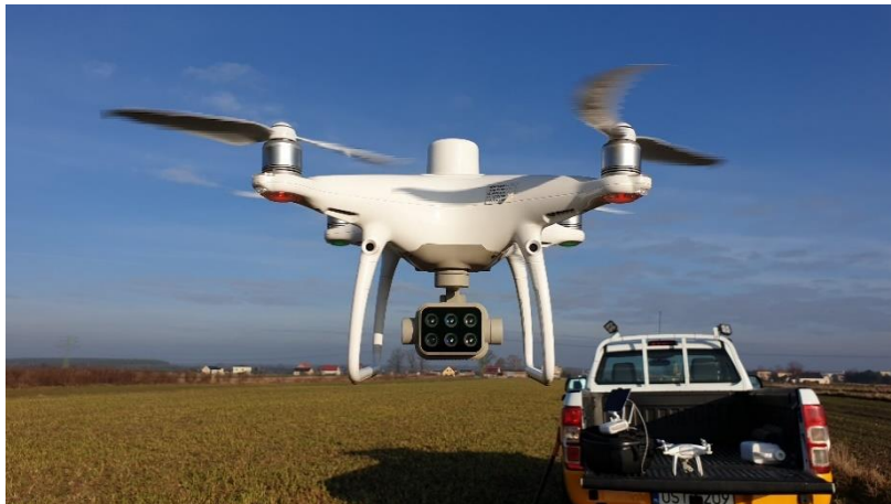
Rysunek 37. Przykładowy zakres kanałów dla wyżej przedstawionego drona DJI P4 Multispectral RTK wynosi: 450, 560, 650, 730, 840 nm oraz ogólny kanał pasma widzialnego RGB.
