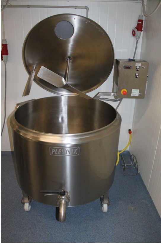
Urządzenie zbiornikowe pasteryzująco – chłodzące Pojemność 300 l
