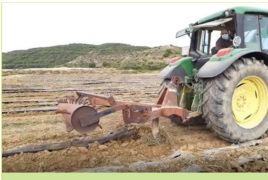
Rysunek 12: Narzędzie do usuwania plastikowej folii do mulczowania z pola za pomocą ciągnika. Plastikowa folia powinna być wystarczająco gruba i mocna, aby wytrzymać proces usuwania.
