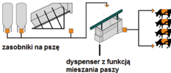
Schemat funkcjonowania automatycznego systemu żywienia krowek mlecznych (uproszczony)
