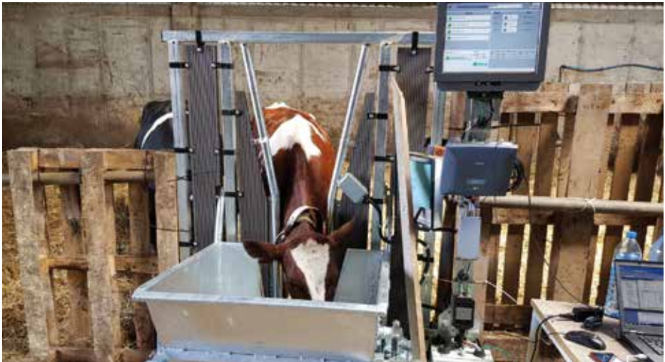
Prototyp urządzenia do badania pobrania pasz oraz behawioru żywieniowego krow
