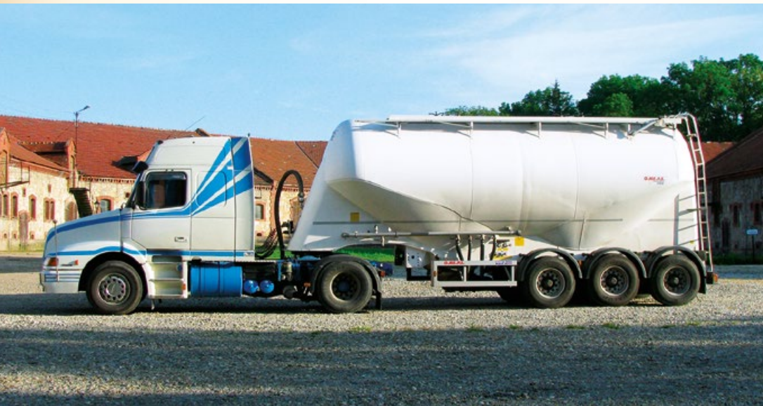
Fot. 6. Autocysterna przystosowana do transportu wapna pylistego
