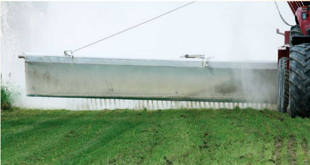
Fot. 7. Belka do wysiewu wapna pylistego w rozsiewaczu konstrukcji firmy POLTOR
