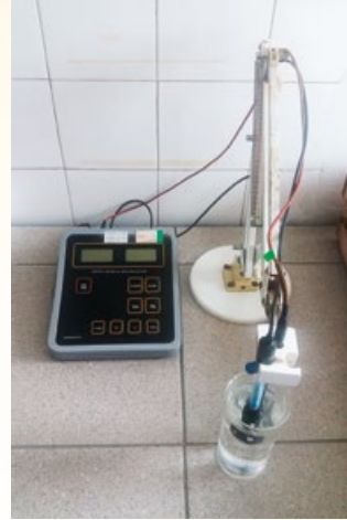
Fot. 3. Pehametr używany do pomiaru stanu zakwaszenia gleb - w warunkach laboratoryjnych (dzięki uprzejmości p. Andrzeja Czarneckiego ze SChR w Krakowie)
