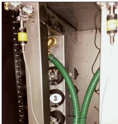
3. Zdjęcie przedstawia moduły plazmy oraz wielopoziomową konstrukcję reaktora niskotemperaturowej plazmy. Źródło: P. Bylicki
