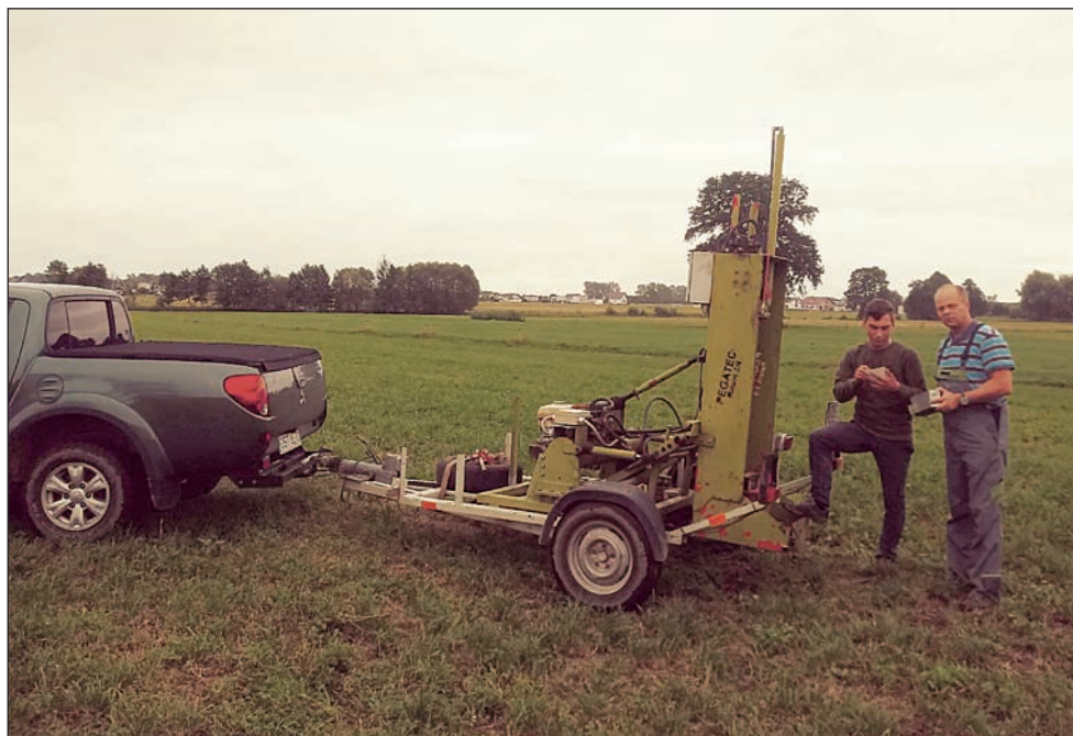
3. Przygotowanie do mechanicznego pobierania próbek glebowych przez zespół kierowany przez Jerzego Koroncoka. Źródło: Stanisław Minta
