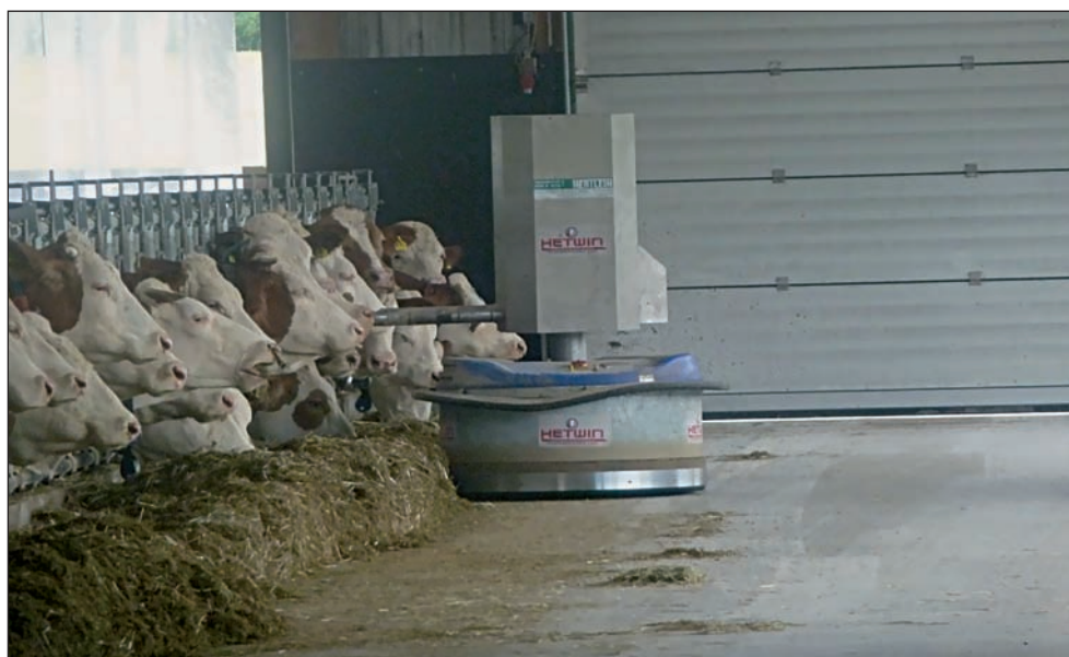
4. Automat do podgarniania pasz objętościowych stosowany w chowie bydła. Źródło: Stanisław Minta
