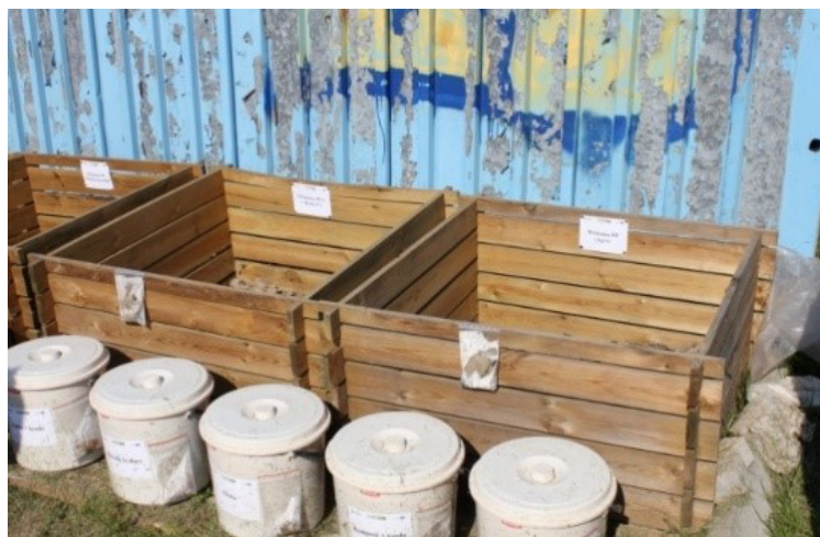
Fot. 1. Kompostowniki dla włóknin z PLA, skrzynie do kompostowania z dostępem tlenu i pojemniki do kompostowania w warunkach beztlenowych [5].
